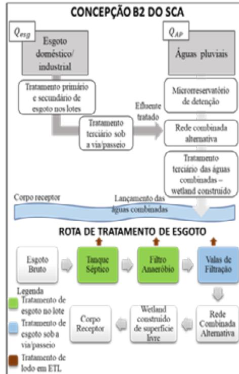
Figura 9 – Concepção B2 do sistema combinado alternativo (SCA).
