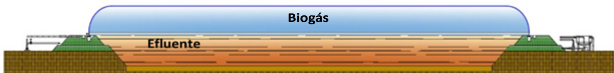
Figura 11 – Desenho esquemático da lagoa coberta, corte longitudinal.
