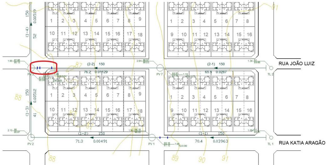
Figura 6 – Interferências inseridas em planta no coletor 2 na rede Conjunto Habitacional.
