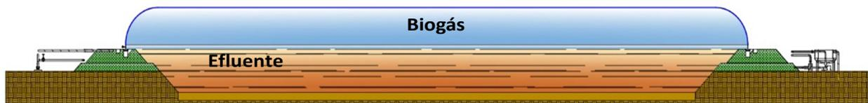
**Figura 11** – Desenho esquemático da lagoa coberta, corte longitudinal.
