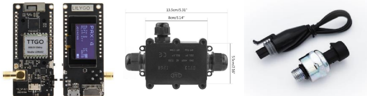
Figura 8 – ESP32 (TTGO Lilygo T3 - v1.6.6, com leitor de cartão microSD) (à esquerda); invólucro IP68 (no meio); e transdutor de pressão 0,5 a 4,5 v com range de 0 a 1,2 Mpa (à direita).
