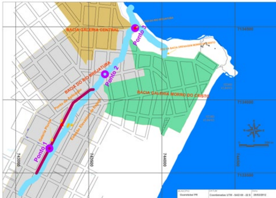
Figura 2- Detalhe do Ponto de Aplicação do desinfetante, da foz do rio Brejatuba, e dos pontos monitorados.
