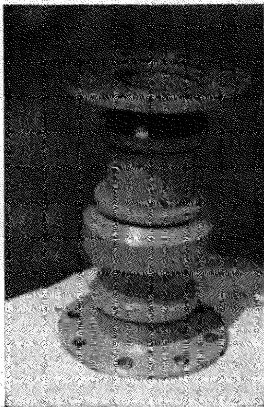
Foto 1 — Vista externa da válvula, fabricada em escala de 1/6, já com flanges de adaptação.
