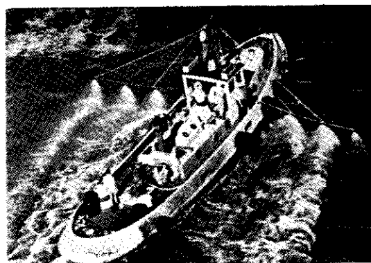
Fig. 3 — Um moderno rebocador, equipado com sistema de pulverização de detergente, em operação no porto de Nova York.
