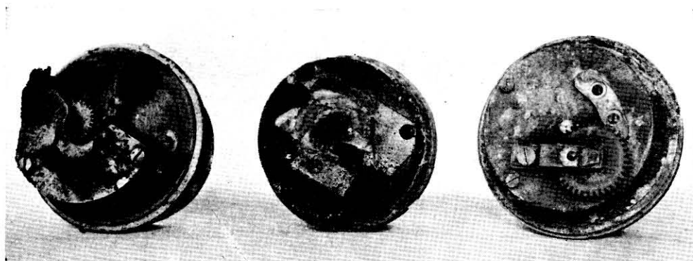
Fotografia n.º 2 — Aspecto da placa onde se acha a engrenagem da ligação do movimento da turbina ao totalizador dos hidrometros estudados, mostrando as concreções
