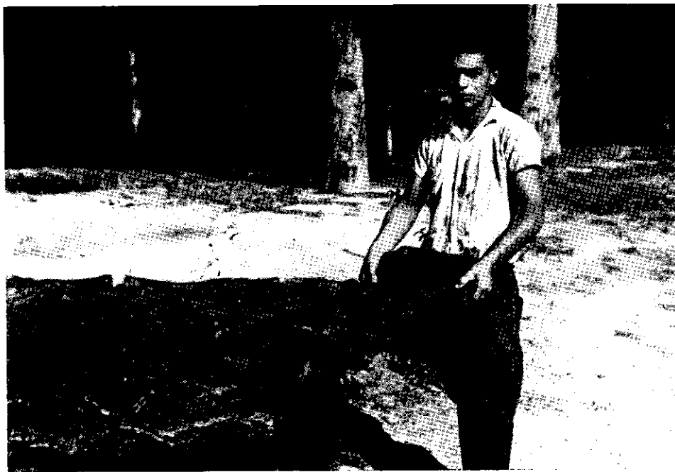
FIG. 7 — O lodo do fundo do tanque, secado num leito experimental (à esquerda), pôde ser retirado sob a forma de placas sólidas.
