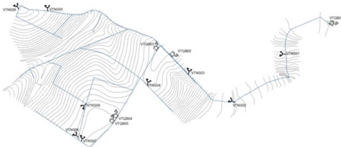
Figura 13 - Localização das ventosas na rede de fertirrigação.
