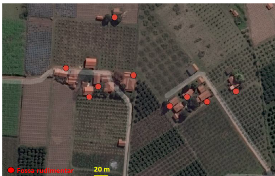
Figura 4 - Mapeamento das fossas rudimentares em área rural de Campinas (SP), mostrando a proximidade entre fossas e residências.
