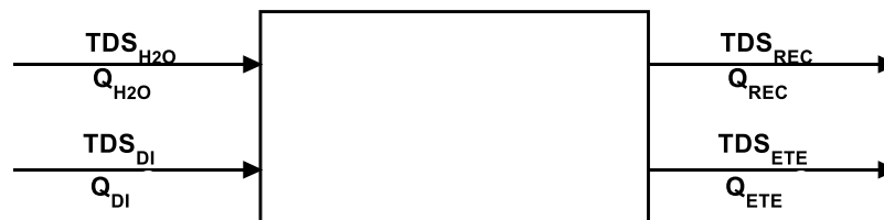
Figura 3 - Balanço de massa genérico para a obtenção do acúmulo de sais no sistema
