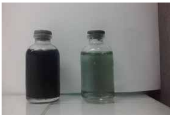
Figura 5 - Amostra da água residuária a 75% preparada para entrada no reator à direita e amostra da saída do efluente tratado no reator de leito fixo e fluxo contínuo num TDH de 12 h.
