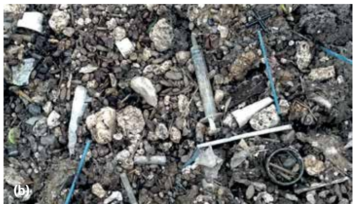
Figura 5 – a) Detritos retidos em uma unidade de peneiramento de 6 mm; b) Presença de detritos em lodo e escuma desaguados em leitos de secagem.
