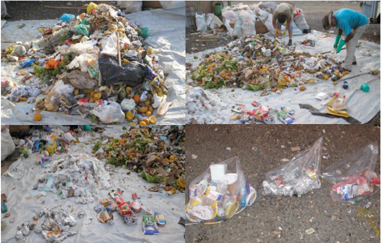
Figura 2: Etapas da caracterização gravimétrica dos RSD
