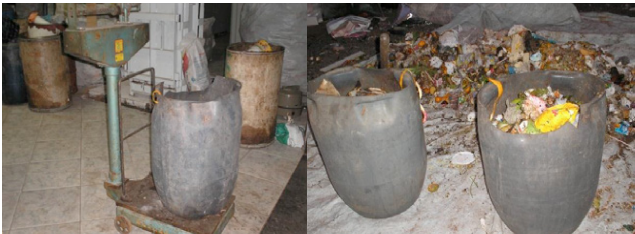
Figura 3: Acondicionamento e pesagem dos resíduos orgânicos resultante da triagem.
