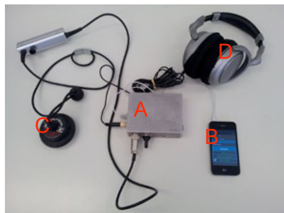
Figura 1 – PDPV constituída por sistema de condicionamento de sinal (A) e unidade computacional portátil (B), além de sensor do tipo geofone (C) e fone de ouvido (D).
