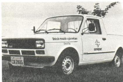
Figura 2 — Um dos veículos da SANEPAR adaptado para o gás metano
