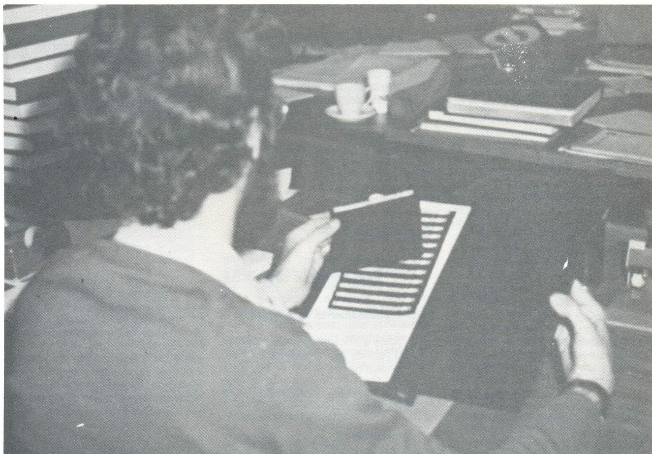
**MICROFICHA PRODUZIDA PELO SISTEMA COM** — A disseminação de informação é feita através de microficha gerada pelo sistema COM "COMPUTER OUTPUT MICROFILM", que a partir de fita magnética gravada em computador produz a microficha.
